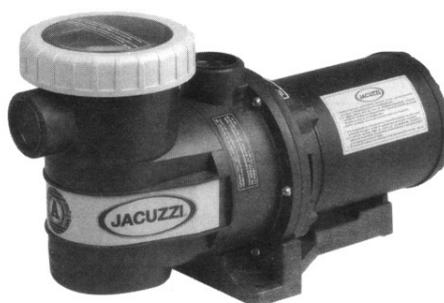
As bombas da série A são centrífugas, auto-escorvantes, com pré-filtro incorporado, totalmente construídas em material termoplástico, com bocais de sucção e descarga adequados para tubulação de PVC marrom colável de 50 mm de diâmetro.
